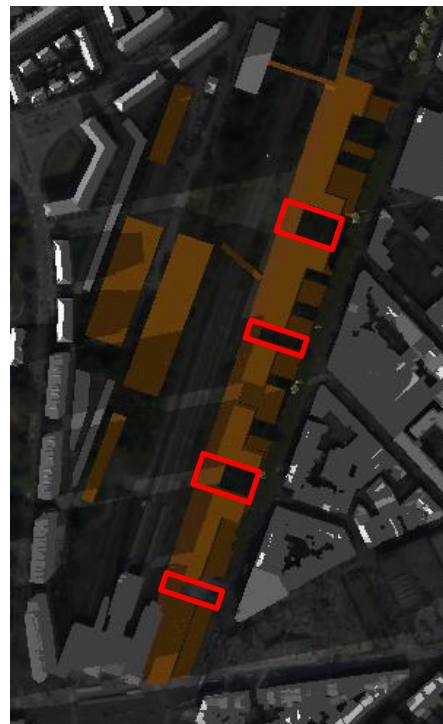
Figure 224 : Simulation des ombres portées sur le quadrant quartier en situation projetée le 20/03 à 18h00 (Source : ABO)
