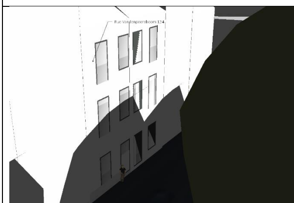
Figure 257 : Simulation des ombres portées sur la rue Vandenpeereboom en situation existante le 21/06 à 17h00 (Source : ABO)
