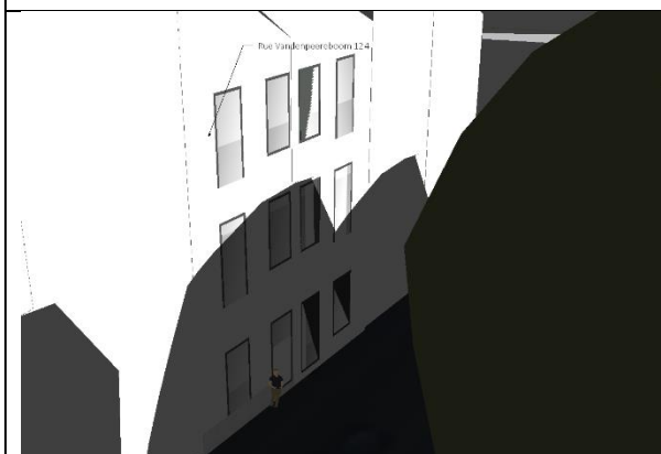
Figure 259 : Simulation des ombres portées sur la rue Vandenpeereboom en situation existante le 21/06 à 17h20 (Source : ABO)
