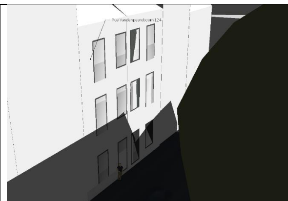
Figure 256 : Simulation des ombres portées sur la rue Vandenpeereboom en situation projetée le 21/06 à 16h40 (Source : ABO)
