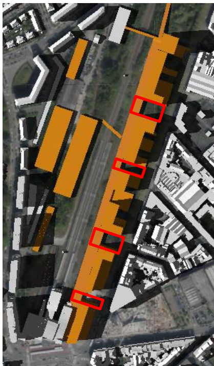
Figure 227 : Simulation des ombres portées sur le quadrant quartier en situation projetée le 21/06 à 17h00 (Source : ABO)
