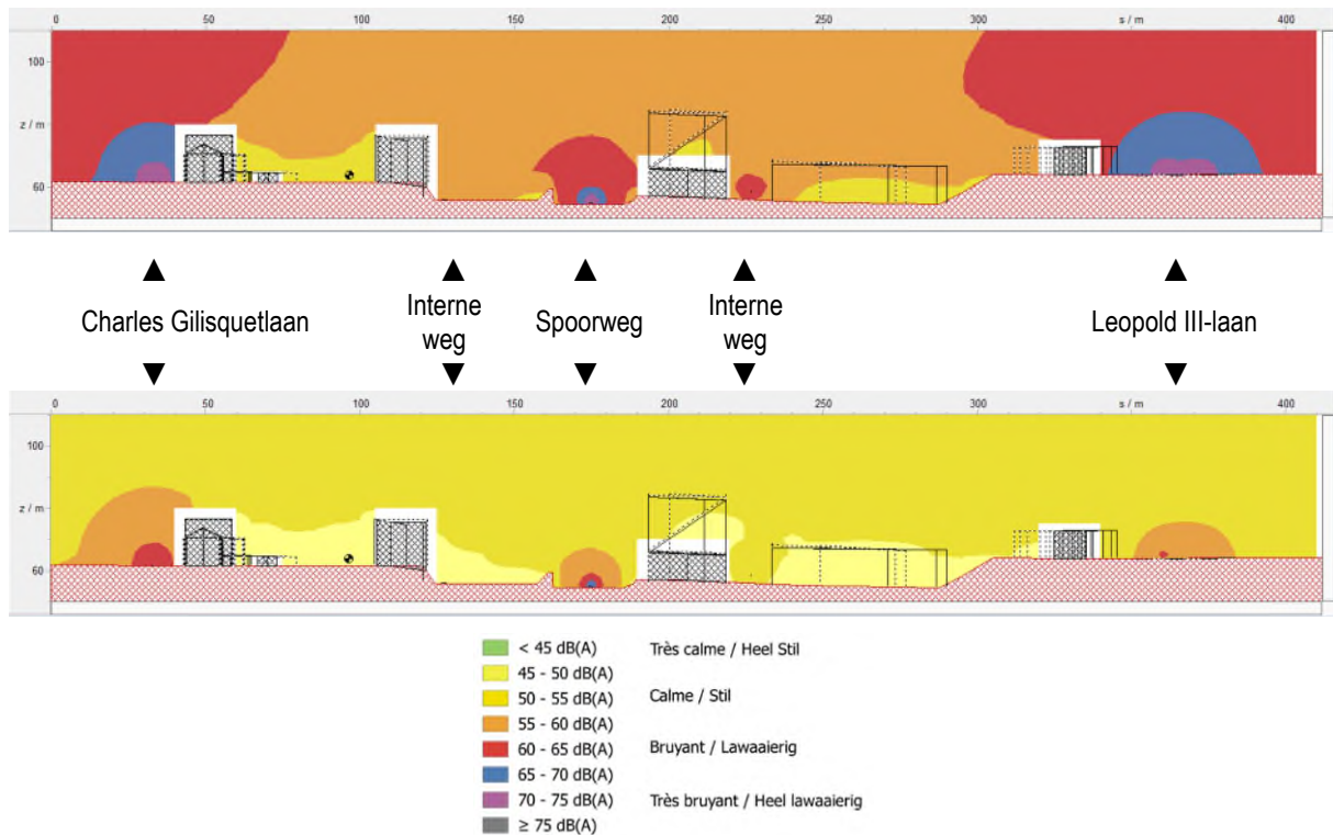
Afbeelding 86: Geluidsdoorsnede A-A, overdag (bovenaan) en 's nachts (onderaan) - Gewijzigd ontwerp van RPA 2021 (ARIES, 2021)
