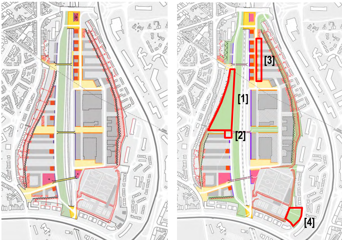
Afbeelding 73: Wijzigingen met betrekking tot de bebouwing tussen het ontwerp van RPA 2019 (links) en het gewijzigde ontwerp van RPA 2021 (rechts) (ARIES, op achtergrond van MSA, 2021)
