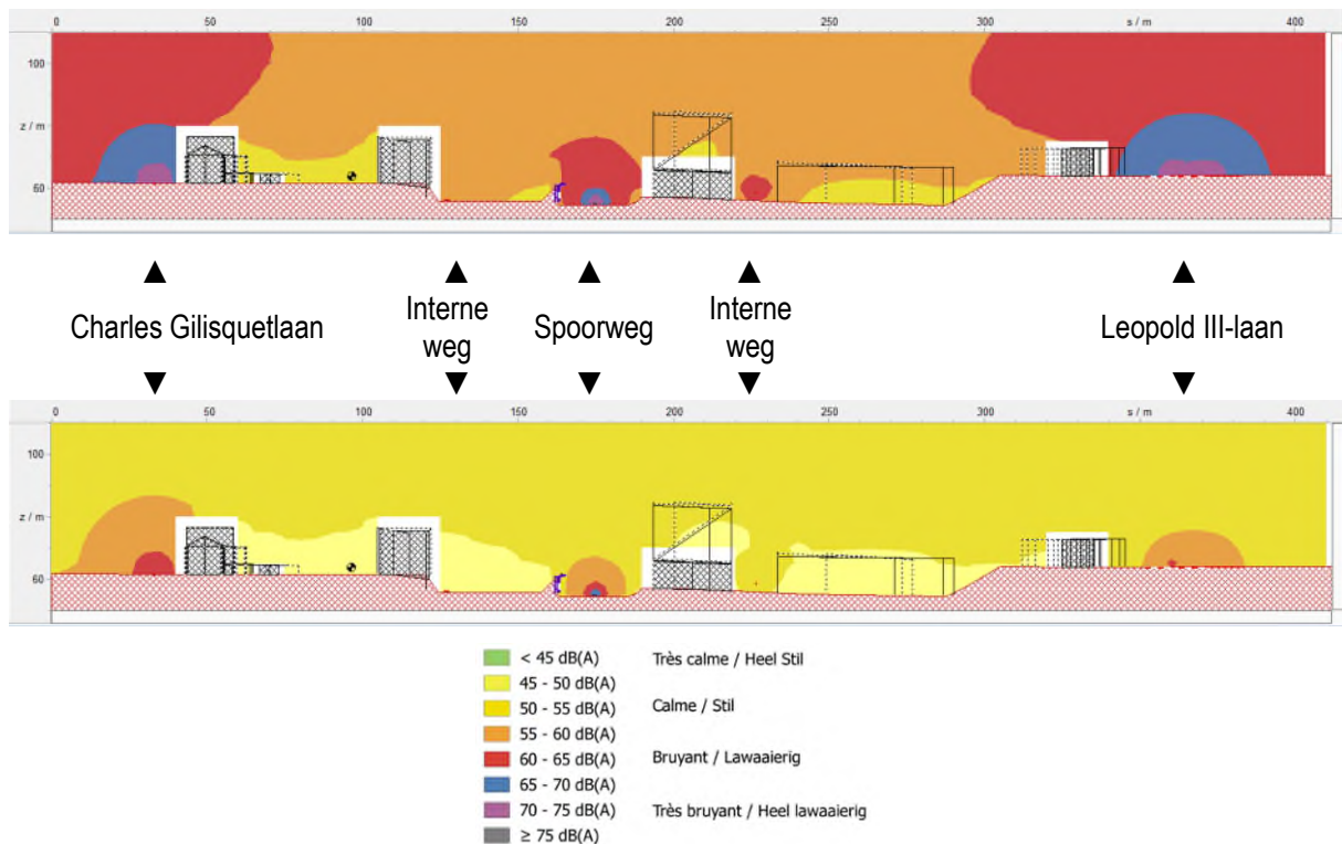
Afbeelding 100: Geluidsdoorsnede A-A: effect van de toevoeging van een scherm met kap - Gewijzigd ontwerp van RPA 2021 (ARIES, 2021)
